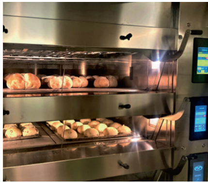
Auf der rechten Seite sind die modernen Displays zu sehen. Mit diesen werden die drei Öfen je nach Backgut programmiert. Dies geschieht schon am PC im Büro.
